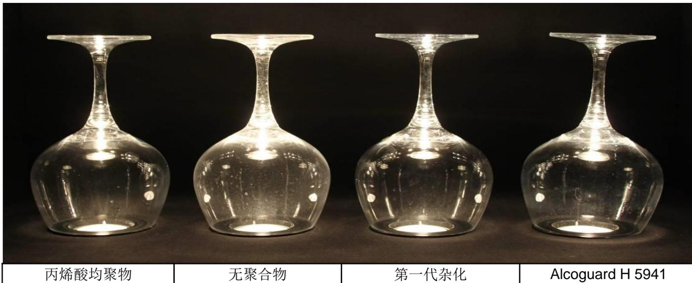
测试配方：11%GLDA, 30%柠檬酸和6%（以活性物计）聚合物；洗涤10个循环；洗碗机：Miele；采用标准：EN50242 modified；水硬度：374ppm
