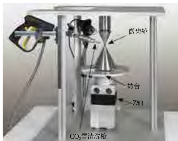
图6 带旋转台，夹紧系统，CO 2 清洗枪和USB摄像头的清洗平台图片
